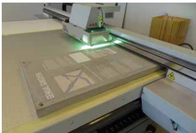
DE TEKST EN TEKENINGEN ZIJN MET EEN SPECIALE DRUKTECHNIEK OP 4 CM DIK HOGESTERKTEBETON AANGEBRACHT.
