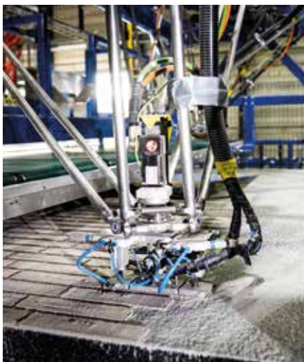
ROBOTS IN DE FABRIEK VAN RC PANELS MAKEN DE GEVEL VOOR DE PILOT IN ENSCHEDA.
