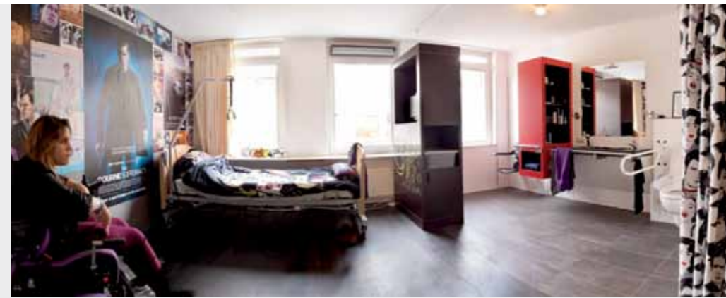
APPARTEMENT IN LEIDEN DOOR ED. BIJMAN GESCHIKT GEMAAKT VOOR ZWAAR GEHANDICAPTE BEWOONSTER IN ROLSTOEL. BELANGRIJKE INGREEP WAS HET WEGHALEN VAN TUSSENWANDEN.
