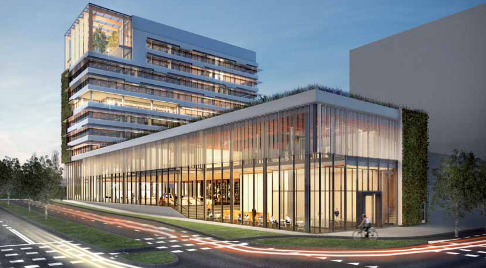
IN DE LUCHTZUIVERENDE GEVEL IS ACCOYA HOUT VERWERKT MET AGC DRIEVOUDIG BEGLAZING.
